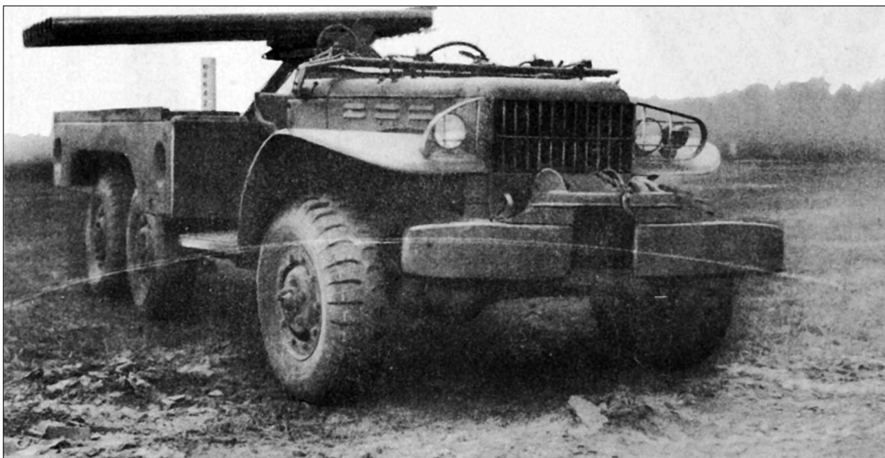
Пусковая установка T27 Хулоhone, смонтированная на базе 1,5-тонного грузового автомобиля повышенной проходимости
