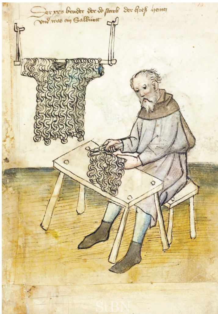
Кольчужных дел мастер, брат Хайнц. На рисунке мастер-кольчужник сидит за столом и держит в руках плоскогубцы, которые он сводит кольца кольчуги. Готовая кольчужная рубашка висит на стене. 1425 год.
