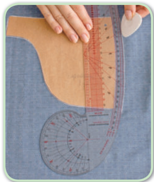
Разметка припусков при помощи «французского лекала» и лекала «угол»
