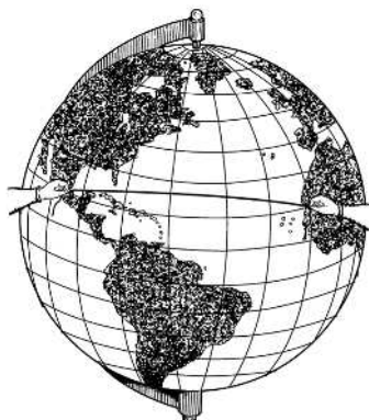
Рис. 3. Простой способ отыскания действительно кратчайшего пути между двумя пунктами: надо на глобусе натянуть нитку между этими пунктами
