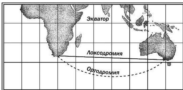
Рис. 1. На морской карте кратчайший путь от мыса Доброй Надежды до южной оконечности Австралии обозначается не прямой линией («локсодромией»), а кривой («ортодромией»)
