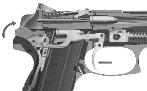
Положение частей пистолета «Грач» перед выстрелом
