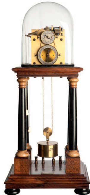
Точность хроноскопа Гуппа позволила ранним психологам, таким как Вундт, с высокой точностью измерять время реакции
