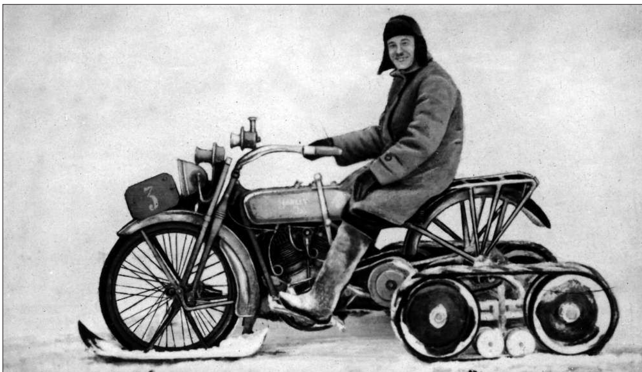
Мотоцикл «Харлей» со сменным гусеничным ходом конструкции Куприянова
